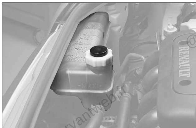
Contrôle du niveau de liquide de refroidissement dans le vase d'expansion.
