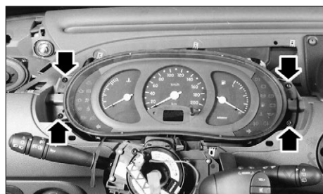
Fixations du combiné d'instruments.
