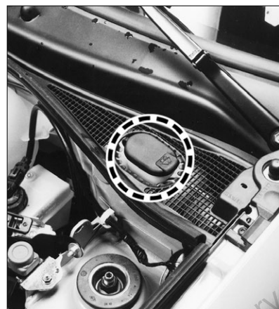
Vérification du niveau du liquide lave-glace.
