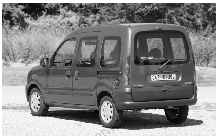
△ À partir de novembre 1999, le Kangoo reçoit de série la porte latérale gauche coulissante, ce qui en fait une véritable voiture familiale. De plus, le hayon sur cette version offre un large volume de chargement allant de 0,68 à 2,8 m 3 .
