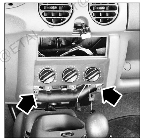
Implantation des vis de fixation du boîtier de commande de chauffage.
