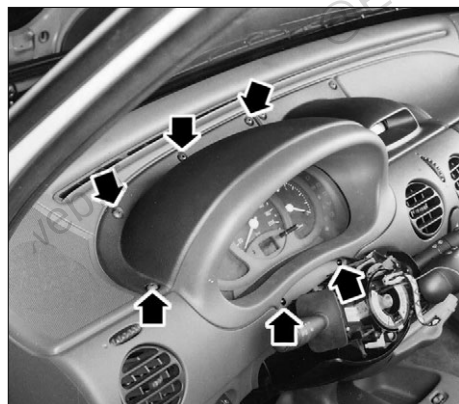
Fixations de l'encadrement du combiné d'instruments.
