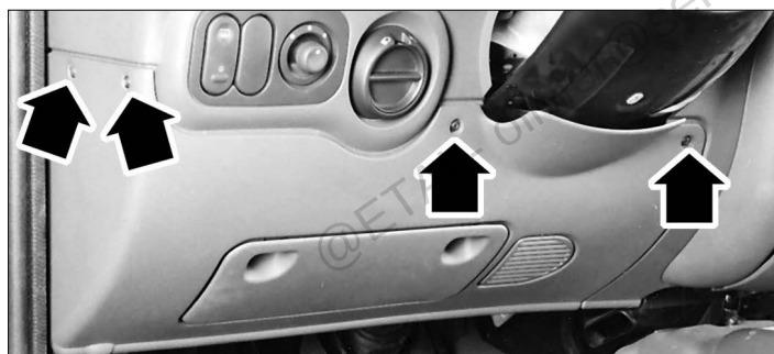
Implantation des 4 vis de fixation de l'habillage inférieur de la planche de bord.
