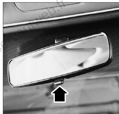
Positionnement jour/nuit du rétroviseur intérieur.
