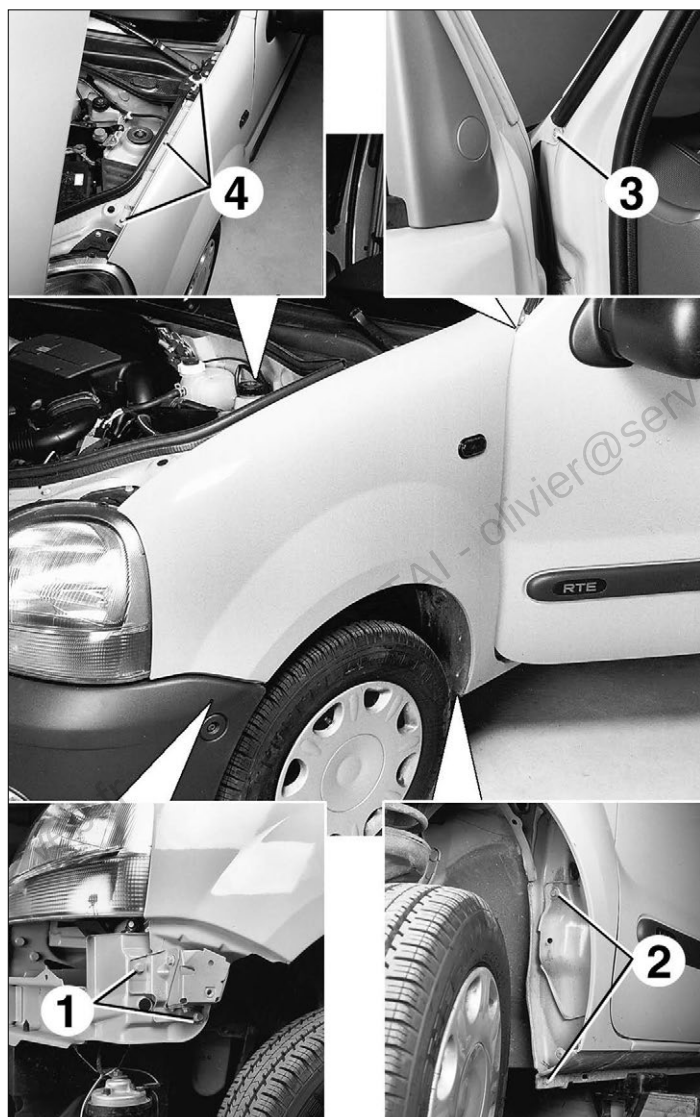
Dépose d'une aile avant 1. Vis à l'emplacement du bouclier - 2. Vis sur le pied de caisse - 3. Vis à empreinte Torx dans l'entrée de porte - 4. Vis supérieures.
