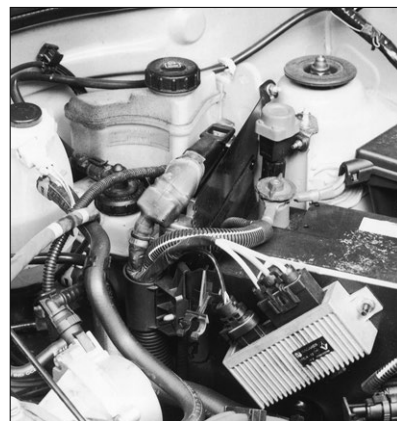
Contrôle du niveau d'huile d'assistance de direction dans le réservoir de compensation.
