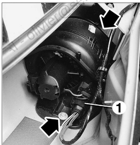
Implantation des vis de fixation du groupe motoventilateur d'habitacle 1. Connecteur électrique.
