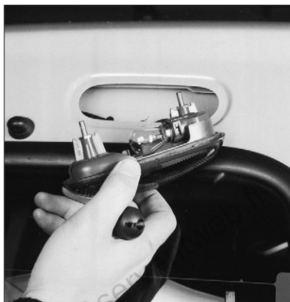
Remplacement d'une lampe de feu stop central en haut : situation des 2 écrous de fixation du bloc. au milieu : dégagement du porte-lampe.
