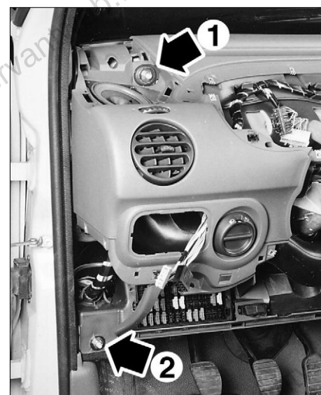
Implantation des vis de fixation de planche de bord 1. Fixation supérieure - 2. Fixation latérale.
