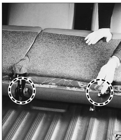
Manipulation des anneaux de verrouillage de l'assise de la banquette arrière.
